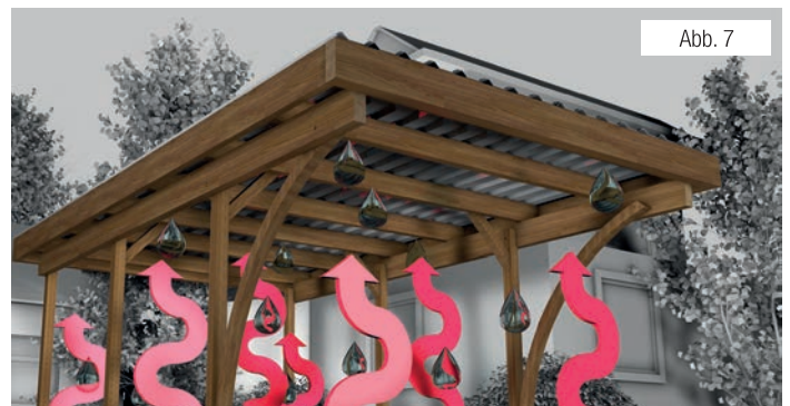
Abb. 7 Feuchtigkeit steigt nach oben und bildet Kondenswasser, das ohne richtige Lüftung von dem Dach abtropfen kann. Deshalb muss für ausreichend Luftstrom gesorgt werden.
