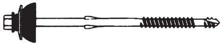
Dachdecker-Bohrschraube 6,5 x 130 mm Edelstahl oder 50 my feuerverzinkt einschl. Edelstahlscheibe 22 mm und EPDM-Spezialdichtung. Schlüsselweite 8 mm.
